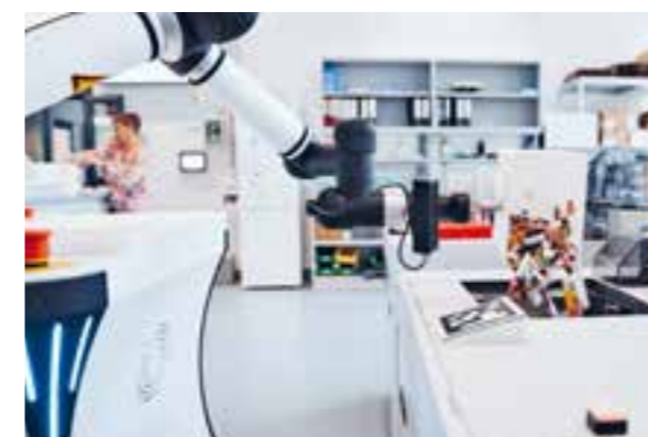
HILFE: Robbie kann eigenständig Röhrchen transportieren und an die Laborstraße übergeben.
