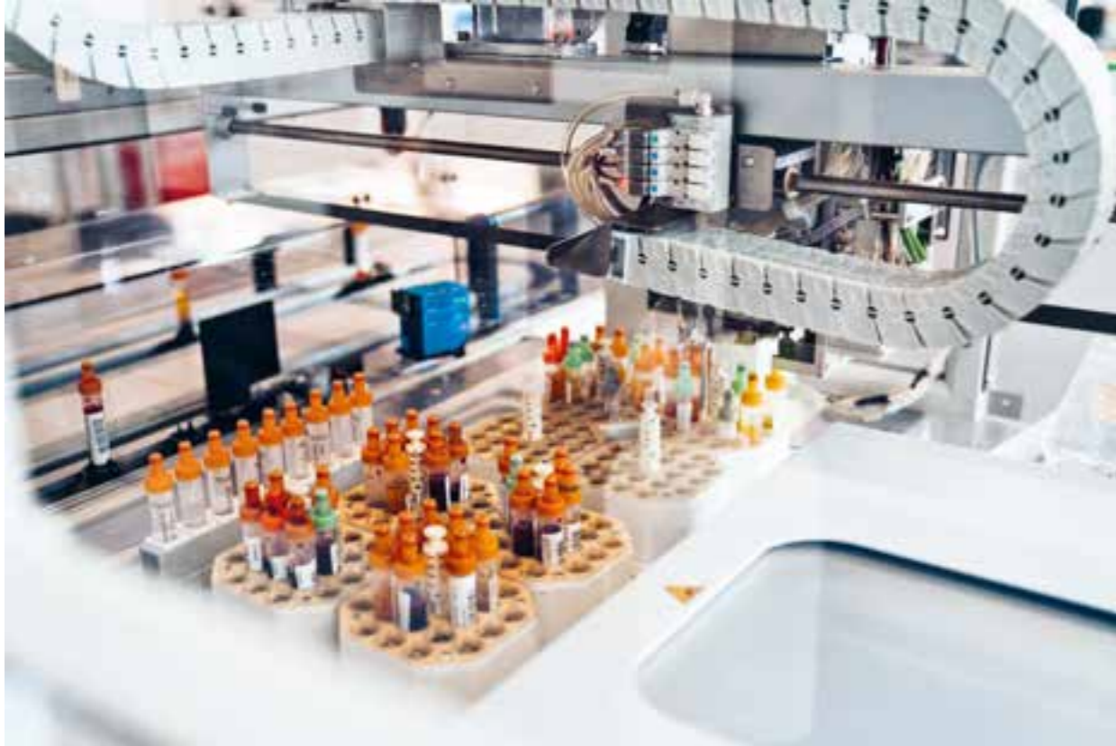
AUTOMATISCH: Ein stationärer Roboterarm überführt Proben von der Laborstraße in den Zentrifugenbehälter.
